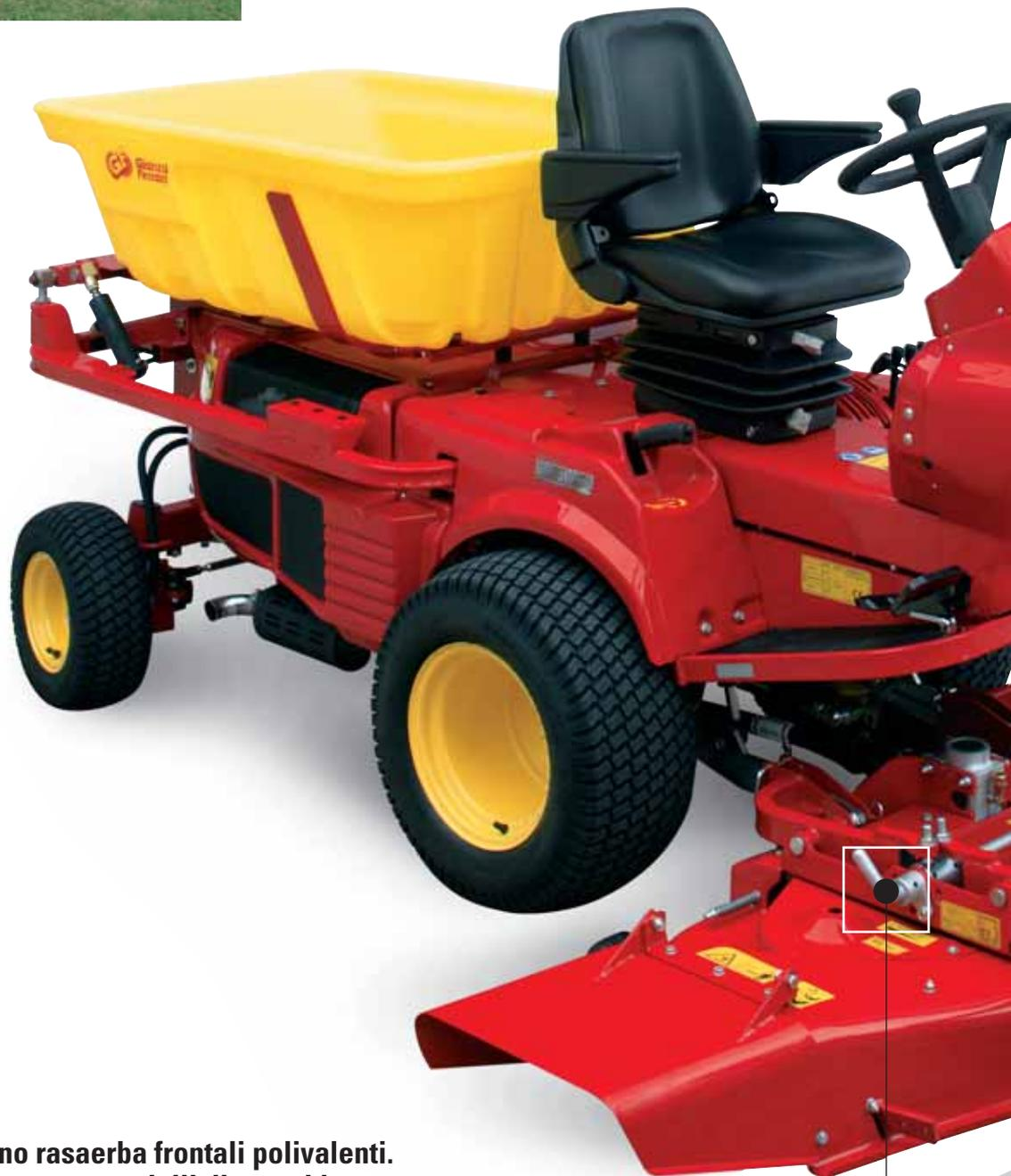
**Le macchine SR sono rasaerba frontali polivalenti. La gamma è composta da quattro modelli di macchine idrostatiche in cui è possibile scegliere tra motorizzazioni benzina e diesel a 2 e 4 ruote motrici. Le macchine SR consentono l'utilizzo di svariate attrezzature per la cura del verde e degli spazi aperti.**
